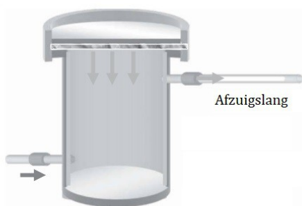
FIGUUR 9.5 Microkamer voor SVOC meting.
