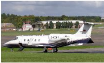
Fig.C.10: "Doe je veiligheidsmanchetknopen om!" Een Bombardier Learjet 60XR vervoert 8 passagiers bij 780 km/u tegen transportkosten van 150 kWh per 100 p-km. Foto door Adrian Pingstone.
