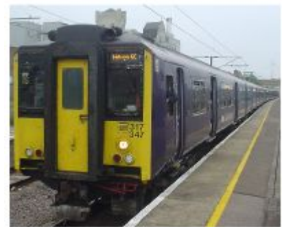
Fig.20.4: Deze trein met 8 wagons verbruikt 1,6 kWh per 100 passagierskilometer wanneer hij vol is bij zijn topsnelheid van 161 km/u.
