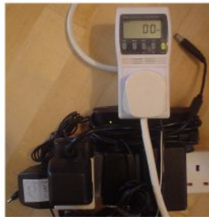
Fig.11.2: Deze vijf opladers - drie voor mobiele telefoons, één voor een handheld PC, één voor een laptop - gaven minder dan één watt aan op mijn meter.
