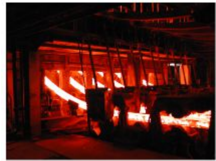
Fig.H.1: Continugieten van staal in een Koreaanse ijzer- en staalfabriek
