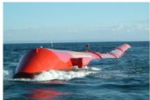
Fig.12.1: Een Pelamis golfenergiecollector is een zeeslang met vier secties. Hij is met de neus naar de inkomende golven gericht. De golven buigen de slang en deze bewegingen drijven hydraulische generatoren aan. Het piekvermogen van een slang is 750 kW. In goede Atlantische omstandigheden kan een slang een gemiddeld vermogen van 300 kW leveren. Foto van Pelamis Wave Power www-pelamiswave-Com (404)
