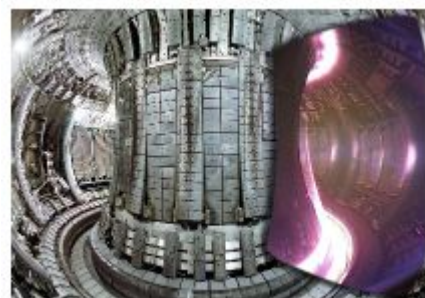
Fig.24.15: (boven) De binnenkant van een experimentele fusiereactor, het JET vacuümvat. Het "plaatje in het plaatje" rechts toont het JET-plasma, genomen met een eenvoudige TV-camera. Foto: EFDA-JET.
