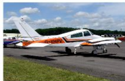
Fig.C.9: Cessna 310N: 60 kWh per 100 p-km. Een Cessna 310 Turbo vervoert 6 passagiers (inclusief piloot) bij een snelheid van 370 km/u. Foto door Adrian Pingstone.
