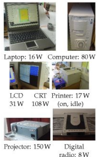
Fig bij Tabel.11.4: Stroomverbruik van verschillende kleine apparaten, in watt. (40 W is 1 kWh/d.)
