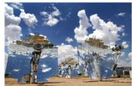
Fig.25.3: Stirling Motor. Deze gevormde reflectoren leveren een vermogensdichtheid per landoppervlak van 14 W/m 2 . Foto met dank aan Stirling Energy Systems. www.stirlingenergy.com
