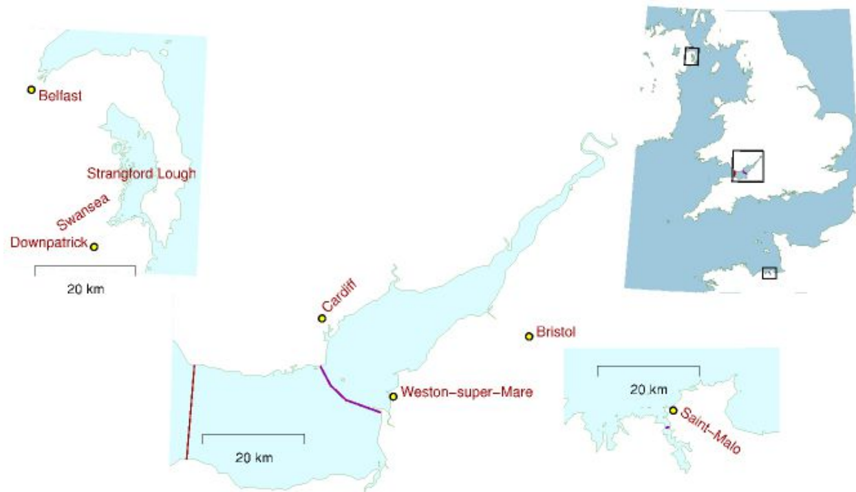
Fig.14.8: De voorgestelde stuw in de Severn (linksonder) en Strangford Lough in Noord-Ierland (linksboven) vergeleken op schaal met de stuw in La Rance (rechtsonder). De kaart toont twee mogelijke locaties voor de stuwdam in de Severn. De variant in Weston-super-Mare zou gemiddeld 2 GW (0,8 kWh/d/p) leveren, de buitenvariant tweemaal zoveel. Een grote getijdenenergiebron bevindt zich in Noord-Ierland: Strangford Lough heeft een oppervlakte van 150 km 2 , het getijdenverschil bedraagt er ongeveer 4,5 m (springtij) of 1,5 m (doodtij) - helaas niet zo hoog als bij La Rance of op de Severn. Het getijdenvermogen is ruwweg 150 MW, verdeeld over de 1,7 miljoen mensen in Noord-Ierland is dat 2 kWh/d/p. De eerste getijdenstroomgenerator van Engeland werd in Strangford Lough in bedrijf genomen.
