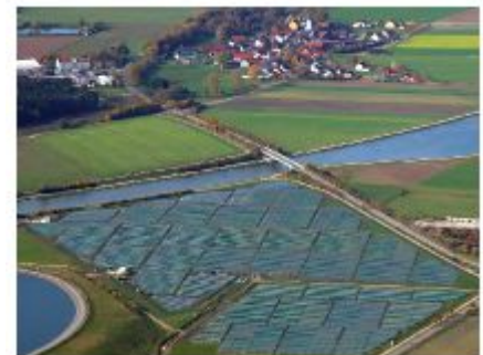
Afb.6.7: Een 6,3 MW (piek) PV-systeem op de grond, het zonnepark in Mühlhausen, Beieren. Het gemiddelde vermogen per eenheid landoppervlak zal waarschijnlijk ongeveer 5W/m 2 bedragen. Foto: SunPower.
