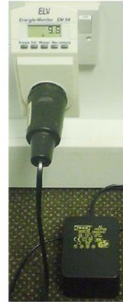
Fig.22.1: Een verschrikkelijke transformator adapter van een Ikea lamp, de adapter verbruikt bijna 10 W als de lamp uit is!
