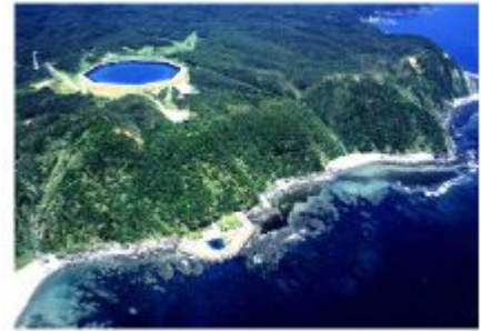
Afb.26.11: (onder) Okinawa pompaccumulatiecentrale, waarvan het staartwater de oceaan is. Opgeslagen energie: 0,2 GWh. Foto met dank aan J-Power www-ieahydro.org .
