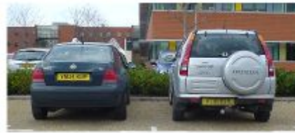
Fig.A.5: Het energieverbruik van een auto is evenredig met zijn contactoppervlak wanneer hij op de snelweg rijdt en evenredig met zijn massa wanneer hij in de stad rijdt. Wie heeft de betere verbruikscijfers, de VW aan de linkerkant, of het ruimteschip?
