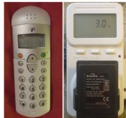
Fig.11.3: Deze verkwistende draadloze telefoon en zijn lader gebruiken 3 W als ze aangesloten blijven. Dat is 0,07 kWh/d. Bij een elektriciteitsprijs van 10 cent per kWh kost die 3W druppel €3 per jaar.
