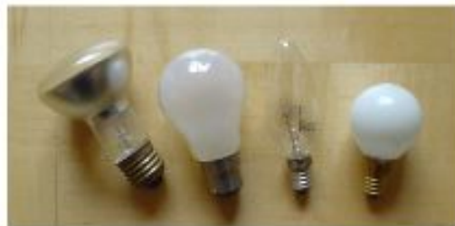
Fig.2.1: Onderscheid tussen energie en vermogen: elk van deze lampen van 60 watt heeft een vermogen van 60 watt wanneer ze branden; ze hebben geen "energie" van 60 watt. Hij verbruikt 60 W elektrisch vermogen en zendt 60 W vermogen uit in de vorm van licht en warmte (voornamelijk warmte).
