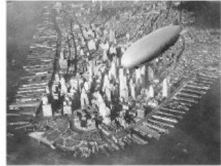
Fig.C.14: De 239 m lange USS Akron (ZRS-4) boven Manhattan. Ze weegt 100 ton en kan een lading van 83 ton vervoeren. Totaal motorvermogen is 3,4 MW, ze vervoert 89 bemanningsleden met wapens bij 93 mph. Ze werd ook gebruikt als vliegdekschip.
